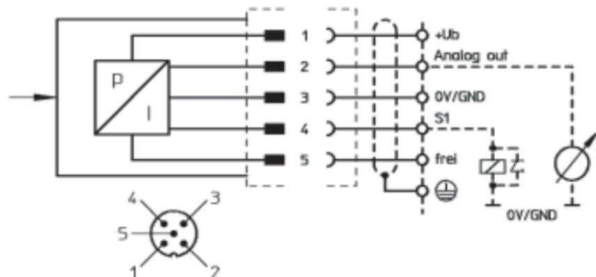
Le diagnostic doit être réalisé de façon implicite. Un courant de sortie < 3,9 mA désigne une coupure de courant ou une panne totale, > 21 mA montre une erreur interne. Dans les deux cas, la diode lumineuse II s'allume.
