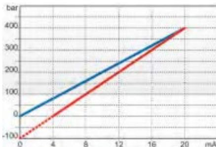
La plage de mesure paramétrée de la sortie analogique s'élève (exemple) de (Fro = 0) à (to = 400) (AnA0 = 0 – 20) mA ou (4 – 20) mA.
