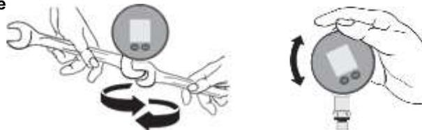
Visser RECORD sur l'installation et le serrer à l'aide de l'écrou 6 pans (couple serrage max. 50 Nm). Un contre-écrou maintient le capteur sur le boîtier.
